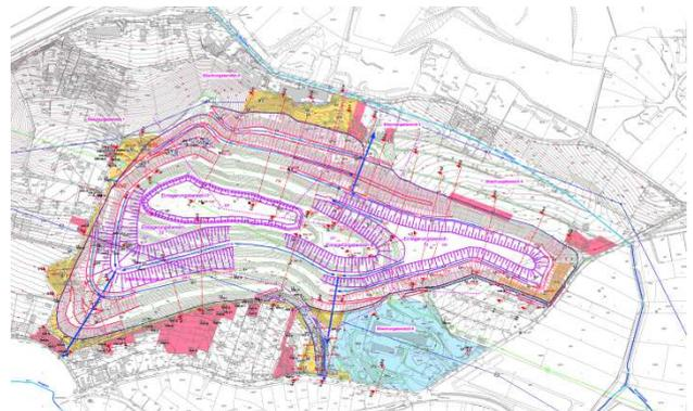
**Abbildung 6: Sanierungskonzept - Endkonturierung Einlagerungsbereiche 1, 2 und 3**
